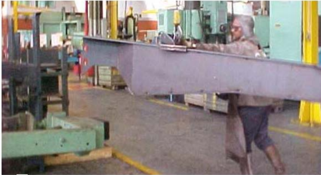
Foto 11: Posiciona Peça Empilhadeira: Operário guiando a talha mecânica. Joelhos semiflexionados, sem utilização de esforço.
