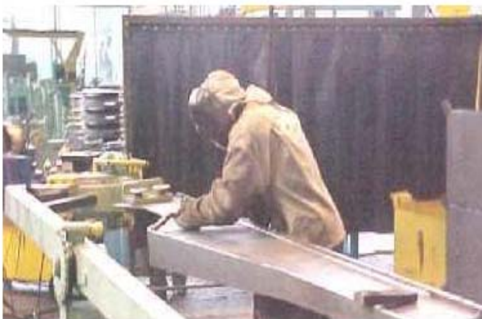
Foto 17: Solda longarina: Operário realizando acabamento das soldas por meio de raspagem de respingos e retirada de rebarbas, com o uso de uma lixa. Apresentando tensão cervical, flexão de tronco, trabalho excessivo de punho, utilizando um pouco de força, podendo ocasionar De Quervain ou túnel do carpo.
