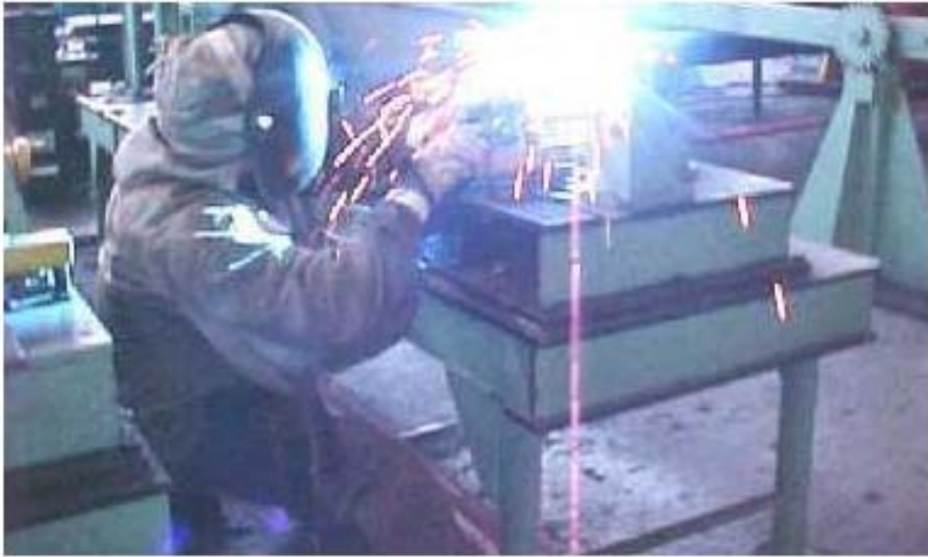
Foto 5: Solda final 1: Operador finalizando a solda de uma peça. Está na posição semi-agachado. Nessas condições deve haver maior disponibilidade de dispositivos giratórios acionados por comandos eletromecânicos, de tal forma a girar a peça e posicioná-la em condições de maior conforto para a execução da tarefa.
