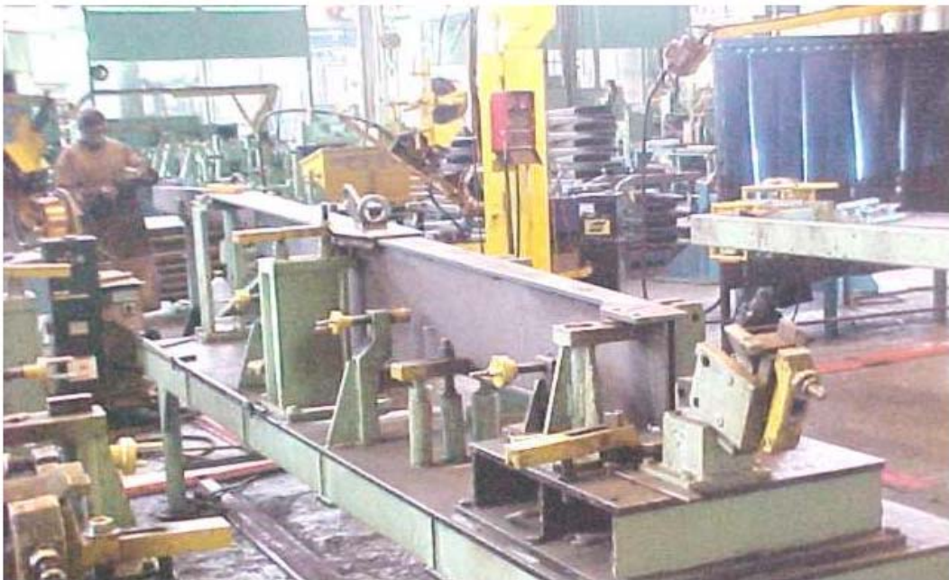
Foto 2: Pré montagem de longarina. Cada peça é colocada no seu devido lugar, para depois dar início ao serviço de soldagem.
