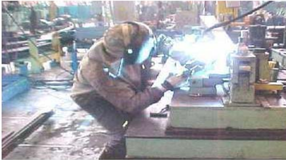
Foto 7: Solda final 3: Inclinação com torção de tronco simultâneas; semi-flexão de joelhos. Propensão à hérnia lombar.
