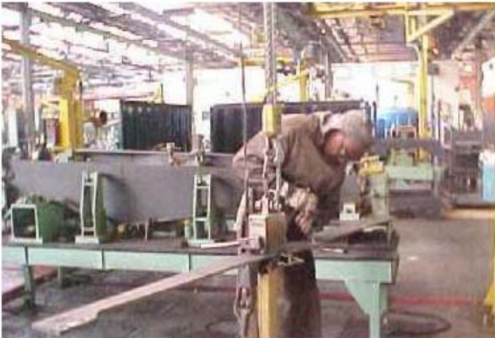
Foto 21: Montagem lateral: Carga sobre região cervical; ombro em tensão e contração; cotovelos fletidos; postura de pé com ausência de semi-flexão de joelhos. Propensão: LER/DORT; síndrome do desfiladeiro; lombociatalgia, levando à síndrome do piriforme.
