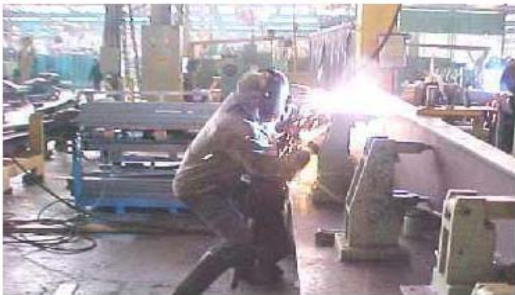
Foto 6: Solda final 2: Operador com joelhos em semi-flexão; flexão de cotovelos e ligeira inclinação de cervical. Neste caso a mesa poderia ter dispositivo de regulagem de altura.
