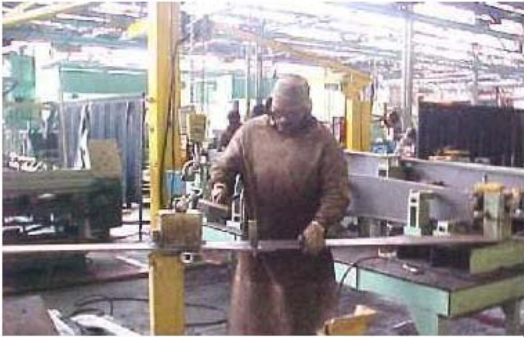
Foto 8: Acaba Furo: O operário finaliza o encaixe do parafuso com o uso do martelo pneumático. Permanece durante todo em semiflexão e tensão de cervical; cotovelo em semiflexão; mão em flexão radial do carpo; flexão de tronco. Predisposição LER/DORT, tendinite do supra espinhoso.
