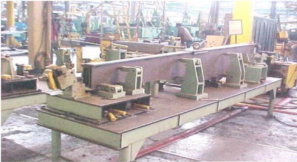
Foto 3: Pré montagem longarina. Peças prontas para serem soldadas.
