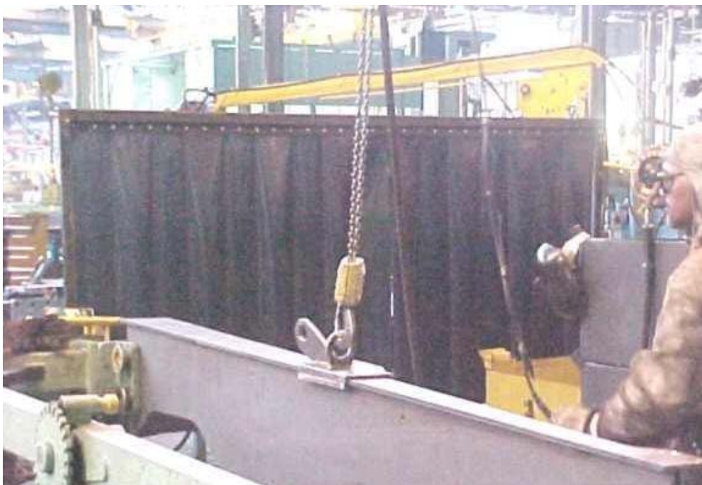
Foto 22: Iça Longarina: Movimentos de peças feitos por meio de talha mecânica giratória; evitando-se riscos maiores para a coluna e MMSS. Mesmo assim podendo causar lombociatalgia pelo tempo prolongado que permanece de pé.
