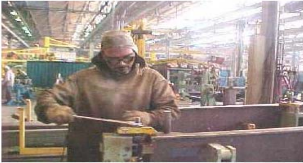
Foto 9: Fixa chapa superior – enroscar o parafuso. Movimento de mão e ombro; cotovelo em semi-flexão. Predisposição: cervicobraquialgia, epicondilite, tendinite do supra-espínho, LER/DORT.
