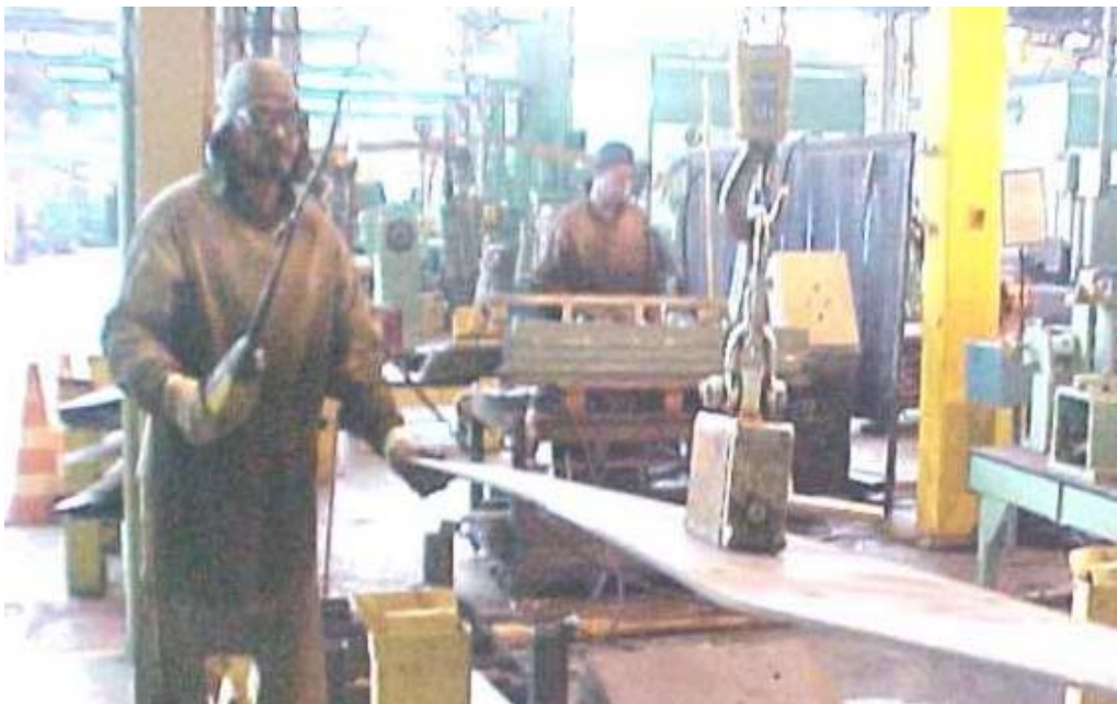
Figura 27: Transporte de Chapas Laterais. Também realizado pela talha mecânica e o ímã. O operador guia o movimento e a localização com o controle manual.
